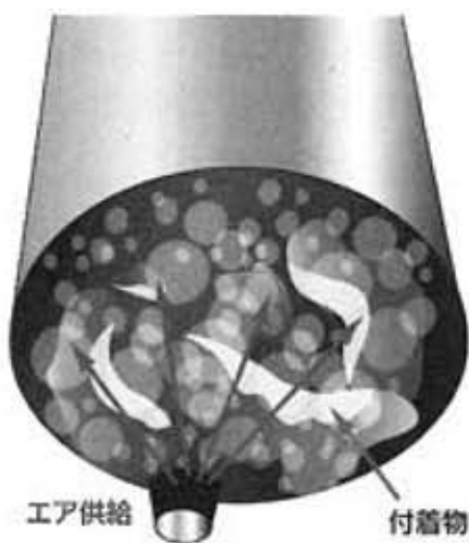
第4図 エアによる発信面の洗浄
