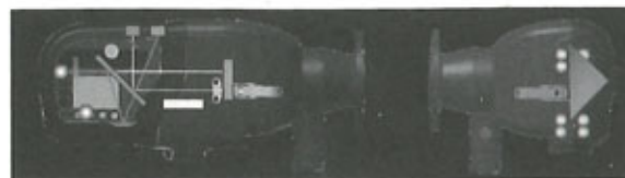
第14図 光透過方式ダストモニター自己診断機能【ZERO】
