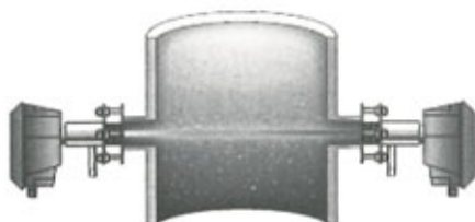
第10図 ダイナミックオパシティ方式ダストモニター 測定原理
